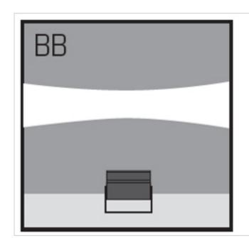
HEIGHT - DIAMETER MAX LUX Hmt.1 - Ømt.0.15 890 Hmt.2 - Ømt.0.30 222 Hmt.3 - Ømt.0.44 99 Hmt.4 - Ømt.0.59 56 Hmt.5 - Ømt.0.74 36
